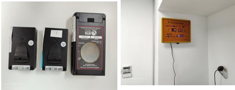
图3-12 本项目配备剂量检测仪器
