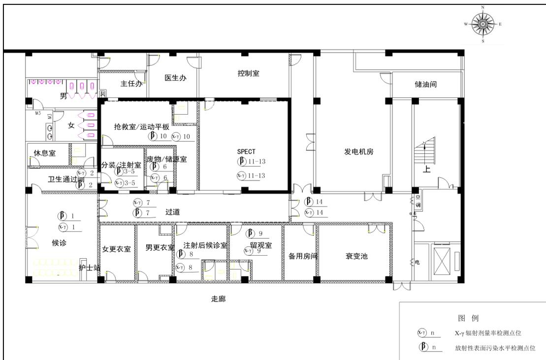
图 7-2 核医学科工作场所 X-γ辐射剂量率现场检测点位示意图
