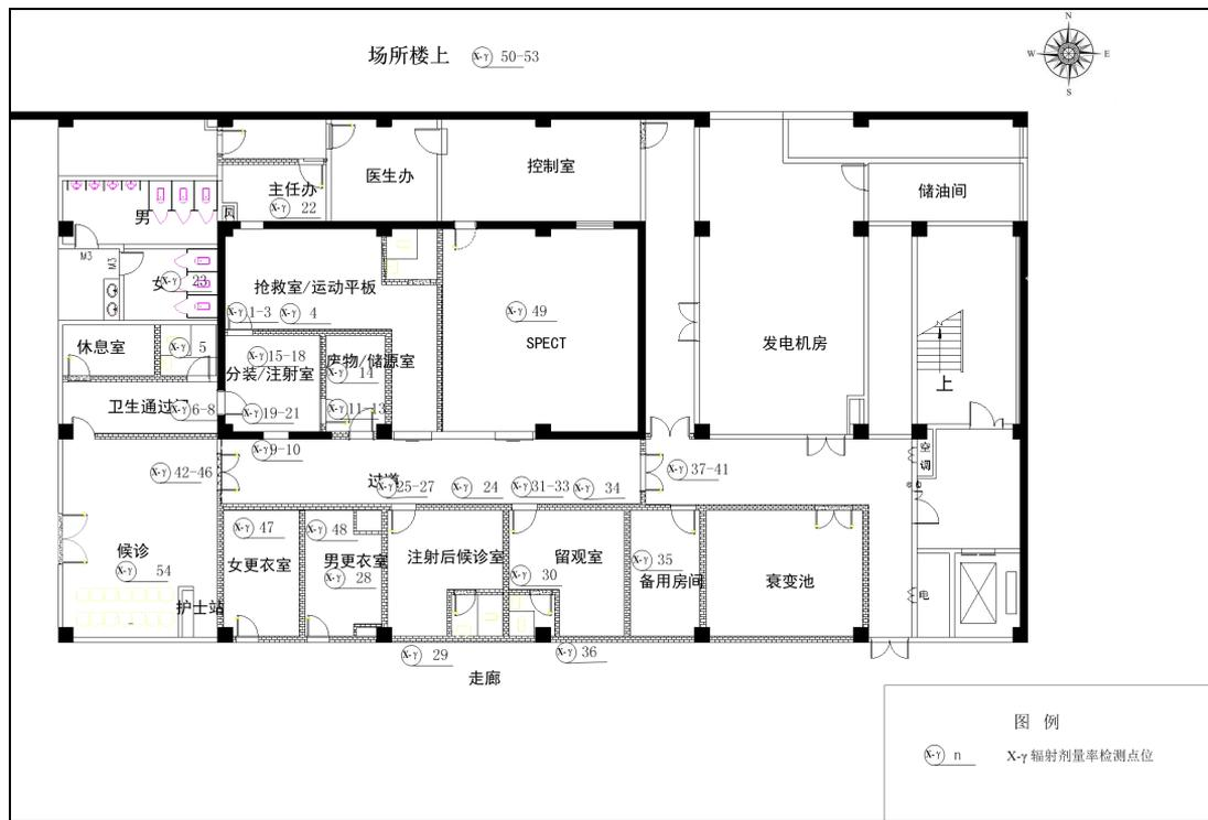
图 7-4 核医学工作场所周围 X-γ辐射剂量率检测点位示意图
