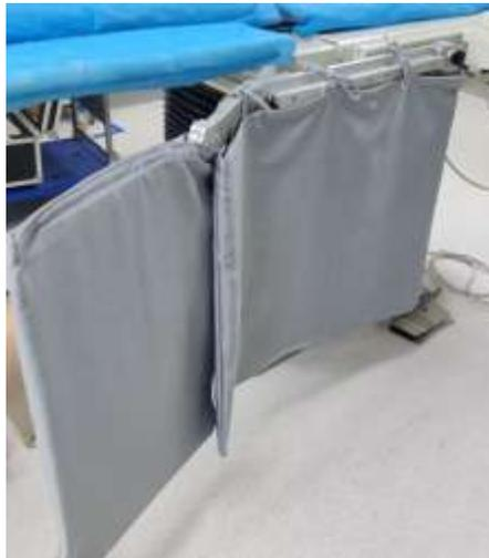
图3-9 DSA设备床侧防护设施
