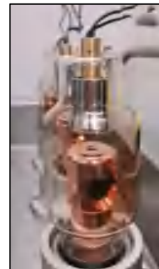
图2-3 高压电源射线一体机内的X射线管
