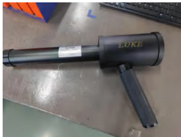
图3-8本项目配备辐射巡测仪
