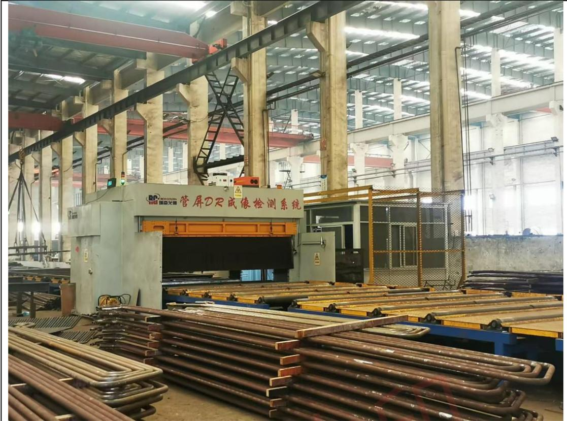
图2-1 管屏X射线成像检测系统及周围环境图
