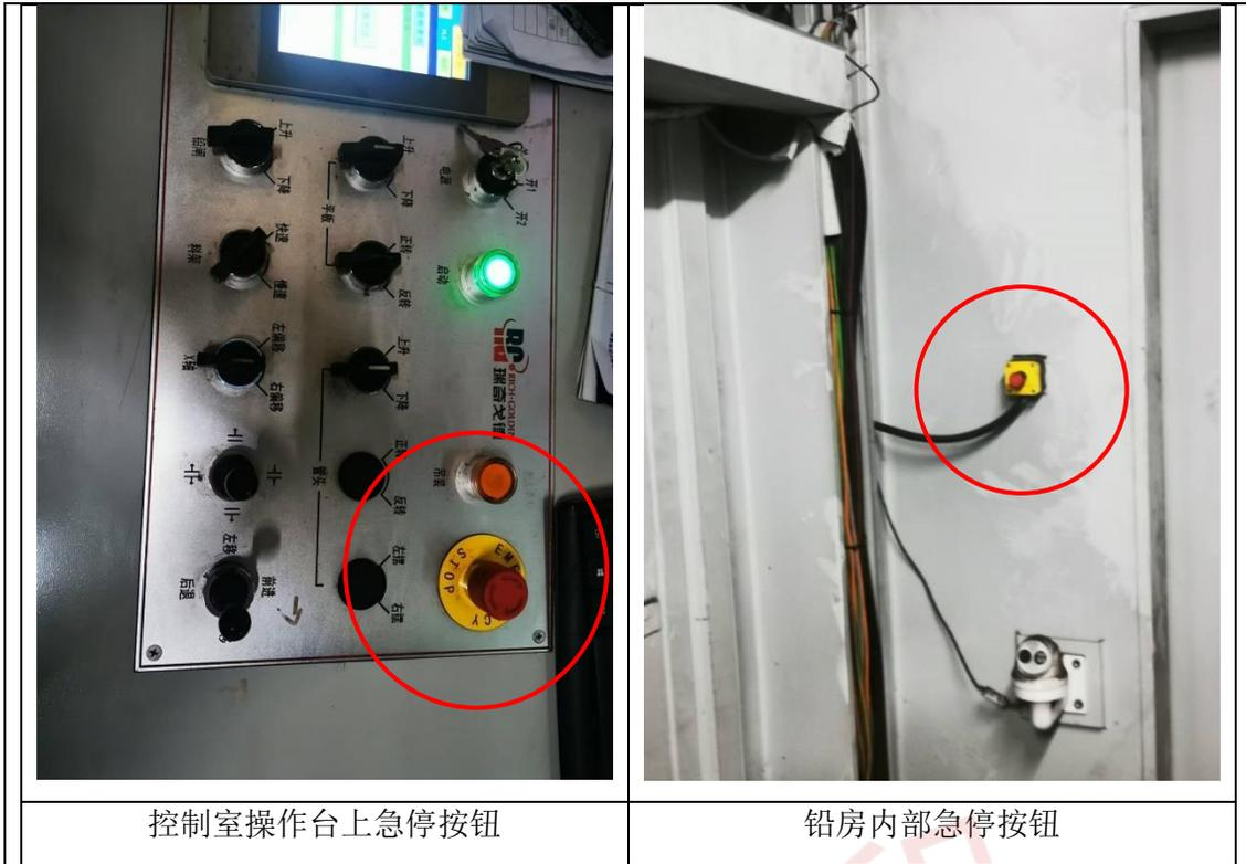
图3-3 管屏X射线成像检测系统设置急停按钮
