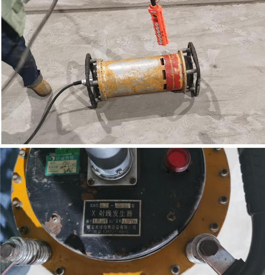
图2-1 X射线探伤机
