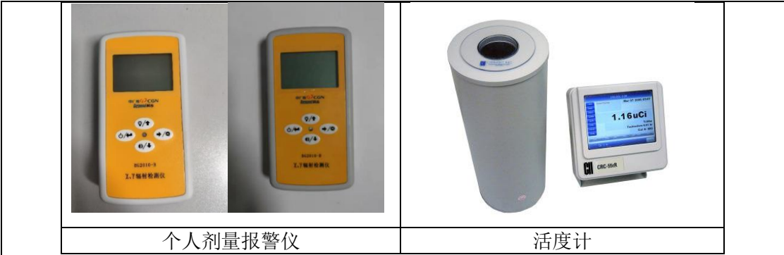
图 3-10 本项目配备辐射剂量检测仪器
