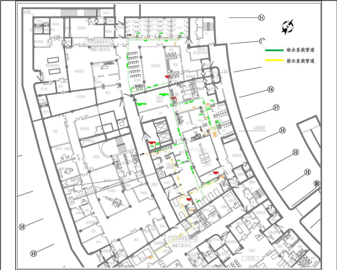
图3-14 衰变池管道及放射性废水流向图
