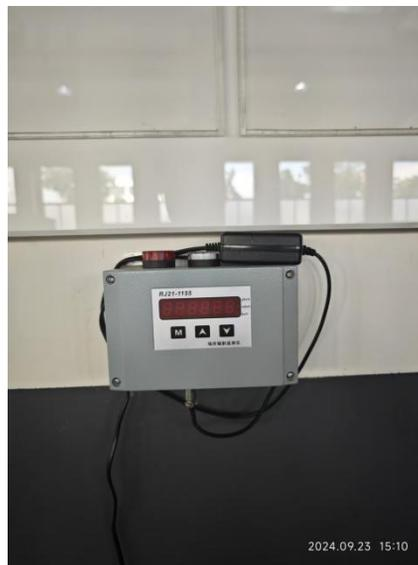
图3-4 固定式剂量监测系统
