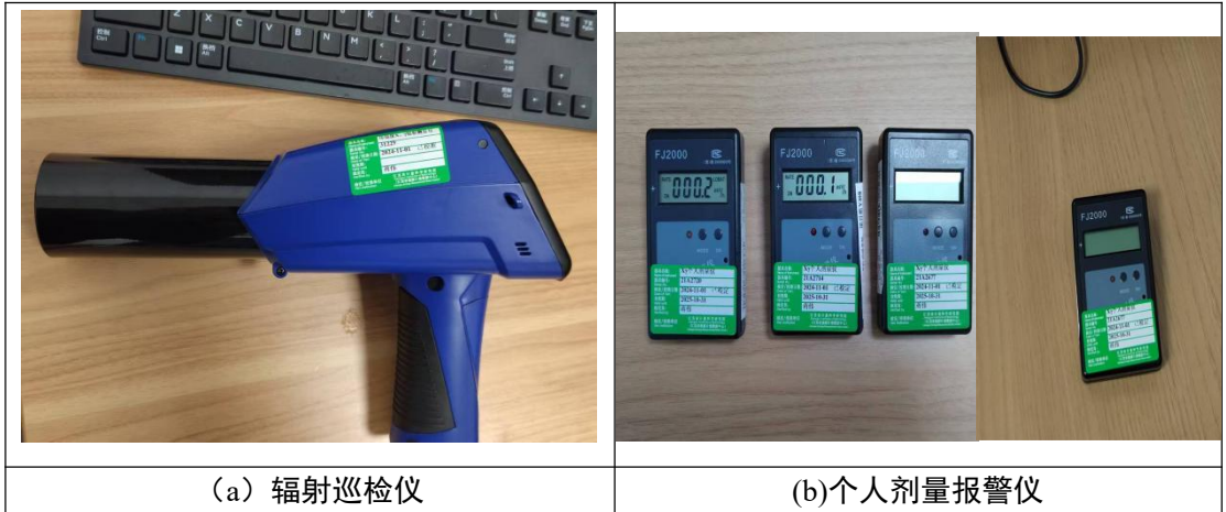
图3-7. 本项目辐射监测仪器现场图
