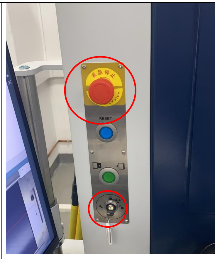
图3-3 本项目高速CT型X射线检测装置设置急停按钮及钥匙开关
