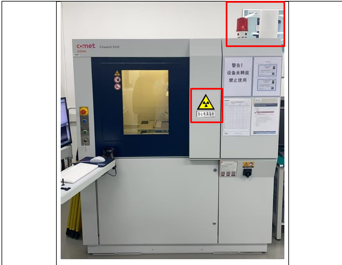
图3-2 本项目检测装置状态指示灯和电离辐射警告标志
