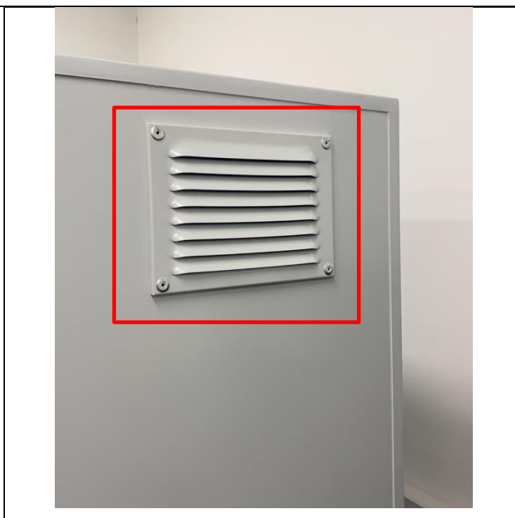
图3-5 本项目高速CT型X射线检测装置排风口设置位置
