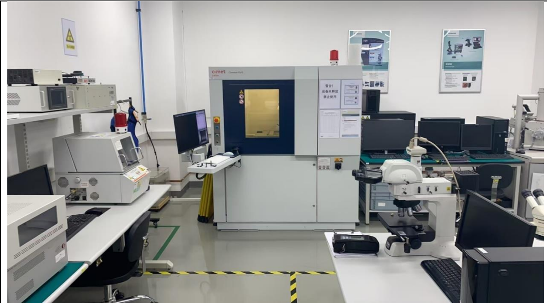
图2-1本项目高速CT型X射线检测装置及周围环境图
